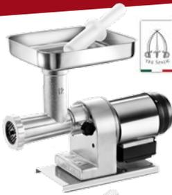
Hachoir Tre Spade (type 12) - 600 W. Pignons nylon. Trémie, socle et carter en acier inox. Corps en fonte étamée. Livré avec un couteau et une grille (Ø 68 mm - Ø trous 6 mm) en acier trempé et un pilon. Moteur asynchrone 260W, 160 trs/min, ce qui donne un très grand couple et une petite vitesse pour ne pas chauffer la viande. Rendement moyen de 60 à 100 kg /h. Poids 11,7 kg. Réf. [hac12elq](#) - **285,00 €**
